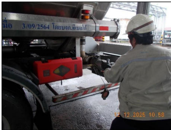
ภาพถ่ายที่ 2.2-15 การตรวจสอบระบบท่อด้วยสายตาระหว่างรับผลิตภัณฑ์ทางรถยนต์
